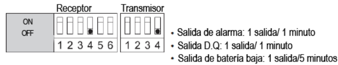
Figura 37. Interruptor DIP y ajustes de salida
